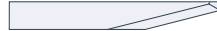
500-9813 -eOT I25 Bıçak 0° - 75° Maksimum Kalınlık (Disk ucu ile birlikte) - 5 mm Maksimum Kalınlık (Disk ucu olmadan) - 6 mm
